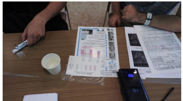
時間を計りながら試薬の色の変化を確認し、1地点につき合計3回のCOD値を測定します。
